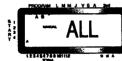
Ilustración 10: Riego semiautomático para las estaciones asignadas a los programas A y B
